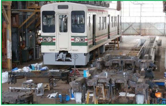
車両全般検査
