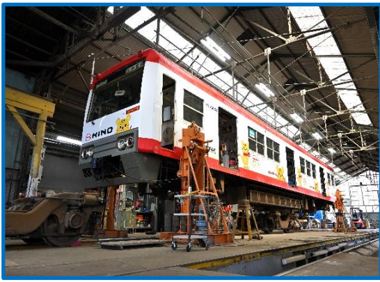
車両全般検査
